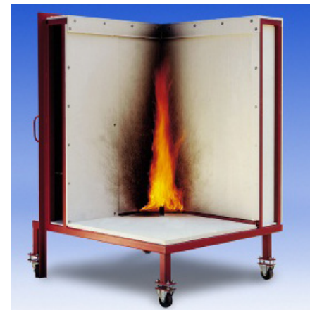
Single Burning Item Test apparatus for EN 13823
